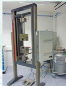
système de refroidissement pour essai mécanique sur polymère (plasturgie)
