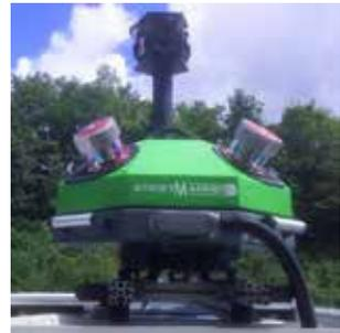
Figure 1 : Système StreetMapper IV monté sur véhicule
