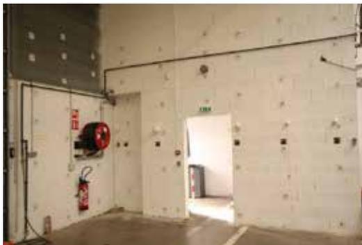
Figure 2 : Les cibles codées utilisées lors de la calibration des caméras
