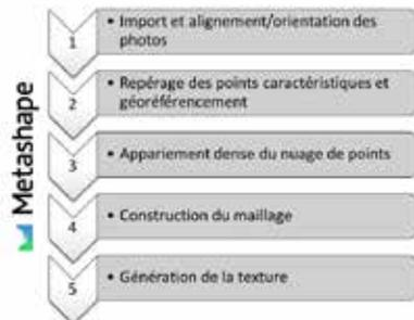
Figure 2 : Chaîne de traitement des données photogrammétriques utilisée avec le logiciel Agisoft Metashape.
