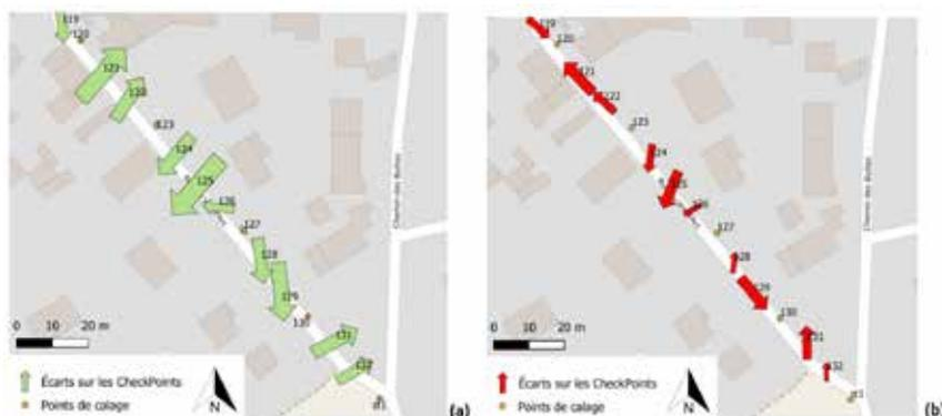
Figure 3 : Représentation de l'orientation des écarts sur les CheckPoints pour une acquisition simple (a) et en aller-retour (b).
