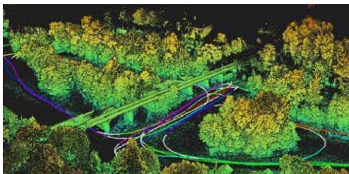
*Figure 5 : extrait du nuage de points final (après traitements et corrections) sous CloudStation. Le visuel montre également la trajectoire du Vx-20 pendant toute la durée de fonctionnement (en blanc et en couleurs).*
