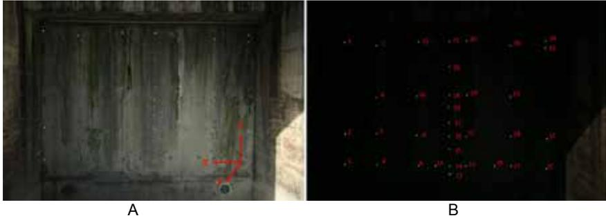
Figure 3: les cibles installées sur la porte d'écluse d'Avignon
