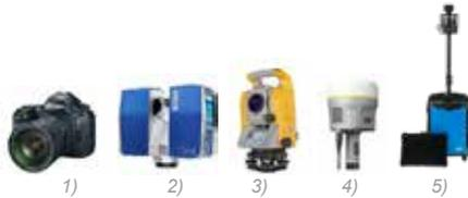
Figure 1 : Instruments utilisés : 1) Caméra Canon EOS 5D SR 2) Scanner laser FARO Focus 3D X330 3) Tachéomètre Trimble M3 4) Récepteur GNSS Trimble R10 5) Scanner laser GreenValley International LiBackpack C50.
