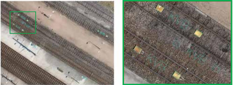
Figure 5 – Résultat d'une insertion automatique avec zoom sur la zone cible présentant l'insertion de 3 balises KVB dont 2 vrais positifs et 1 faux positif
