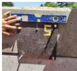
Figure 4 : Plaque d'accueil d'un capteur sur un lest en béton
