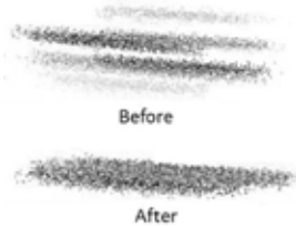
Figure 7: Nuage de point sur cible plane obtenu avant et après calibration (Ravi et al., 2018)
