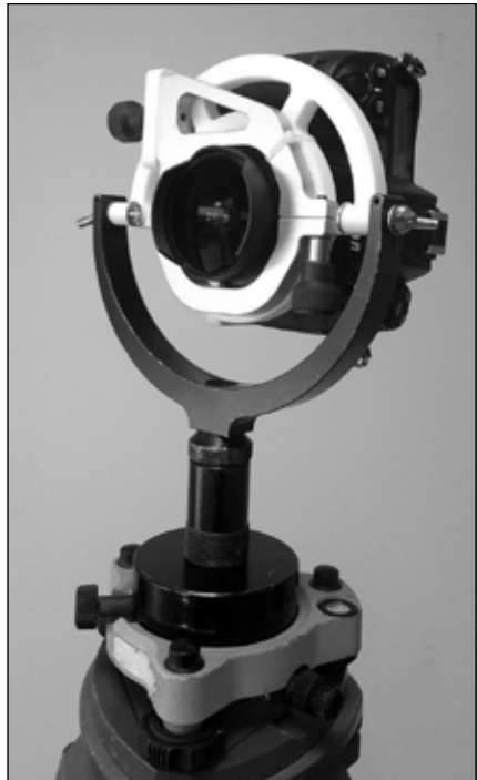
Figure 1 - Système « nodal » Fugro GEOID permettant à l'appareil de tourner autour de son point de pupille d'entrée.
