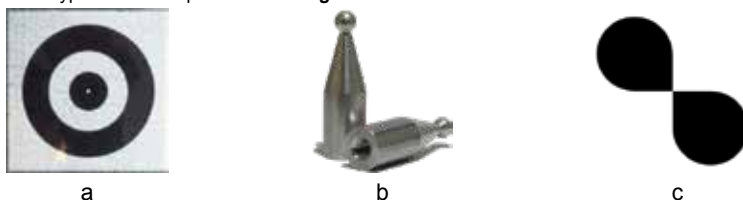
Figure 1 : Cibles passives étudiées : (a) Cocarde en lave émaillée, (b) Bille en aluminium, (c) Damier arrondi
