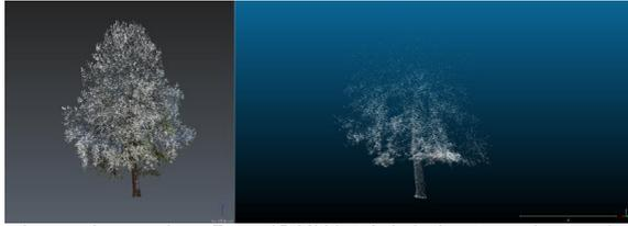
Figure 6 - A gauche un arbre acquis au Focus 3D X330 et à droite le même arbre acquis au Zeb-Revo RT
