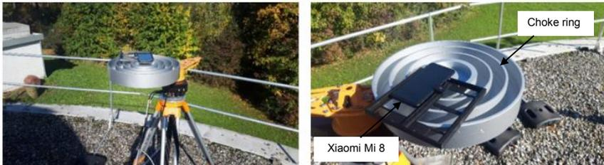
Fig 1 : Dispositif mis en place pour l'acquisition de données dynamiques avec une antenne choke ring
