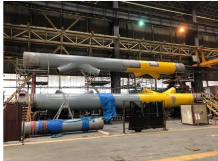
Figure 4 Assemblage de la colonne centrale du support d'une éolienne
