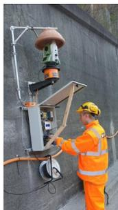
*Figure 2 : déploiement du système informatique MAPADMS et du matériel nécessaire pour un chantier réel de surveillance automatique de tunnel*
