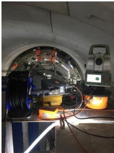
Figure 5 : Prisme permettant l'orientation du TS15
