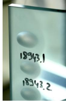
Figure 2 : empreinte de béton      Figure 3 : empreinte de BFUP      Figure 4 : empreinte de verre
