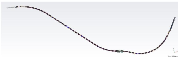
Figure 2 : Nuage final du tunnel
