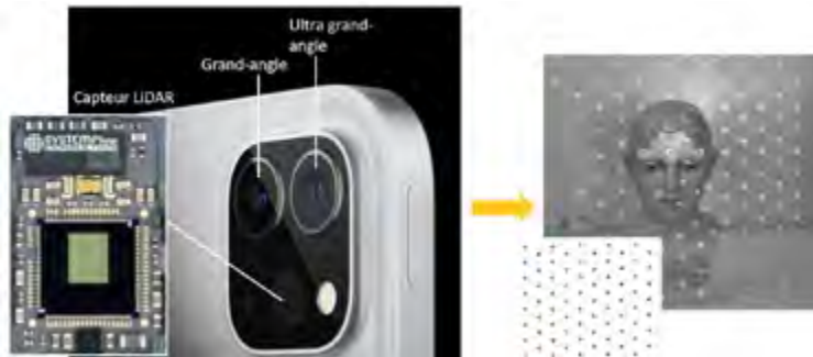
Fig. 1 : A gauche (a), module LiDAR sur l'iPad Pro (System Plus Consulting@2022, et Apple iPad Pro@2022, modifié), à droite (b), exemple d'un extrait de la matrice de points du capteur LiDAR de l'iPad (Spreafico et al., 2021, modifié, et Medium@2022, modifié)
