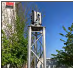
Fig. 2 : Tachéomètre sur pilier
