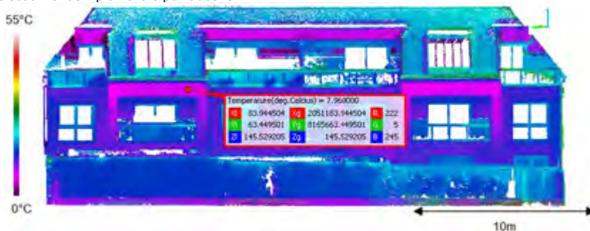
Fig. 1: Nuage de points thermiques d'un bâtiment
