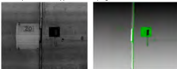
Fig. 1 : Exemple d'images d'intensité (à gauche en niveau de gris) et de profondeur (à droite) : niveau de gris selon la profondeur et valeurs invalides / hors limites sont marquées en vert (Tual et al., 2021)
