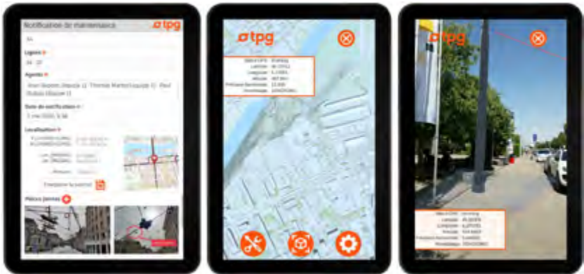
Fig. 4.2 : De droite à gauche – formulaire d'avarie sur LAC, navigation en 2D, BIM en réalité augmentée sur surface détectée dans l'application développée dans le cadre du PFE
