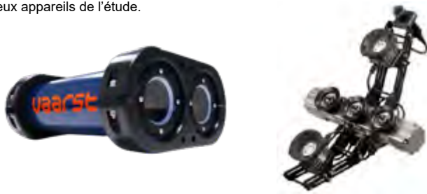
Fig. 2 : SubSLAM de VAARST (à gauche) - 3DRecon de ZUPT (à droite)
