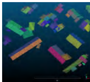
Fig. 3 : Détection des plans de chaque toiture
