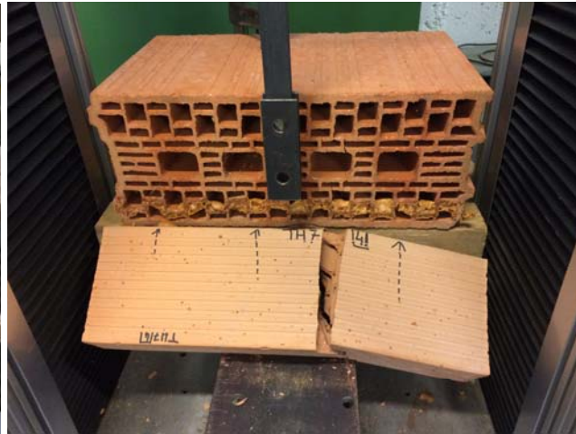
Exemple d'essai au poinçonnement d'une membrane d'étanchéité type EPDM – Exemple d'essai au cisaillement d'une planelle collée sur une brique en terre cuite
