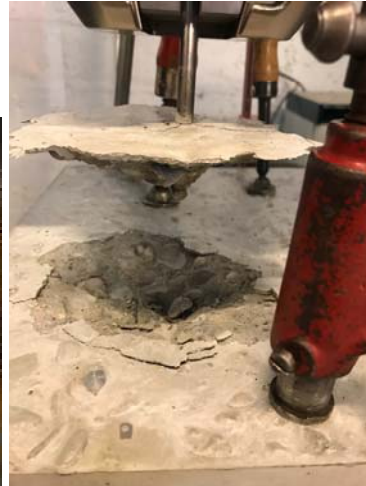
Banc de flexion dans son environnement d'origine – Exemple d'essai à l'arrachement de connecteur inox dans une peau de prémur
