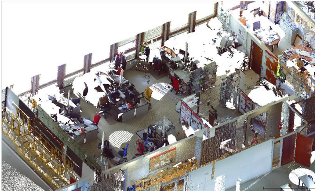
Vue d'un nuage de points issu d'une acquisition par scanner laser terrestre
