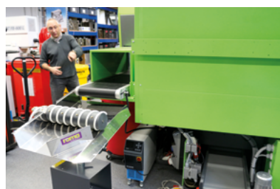
Trieur et tapis de convoyage pour presse à injecter [spécialité plasturgie]
