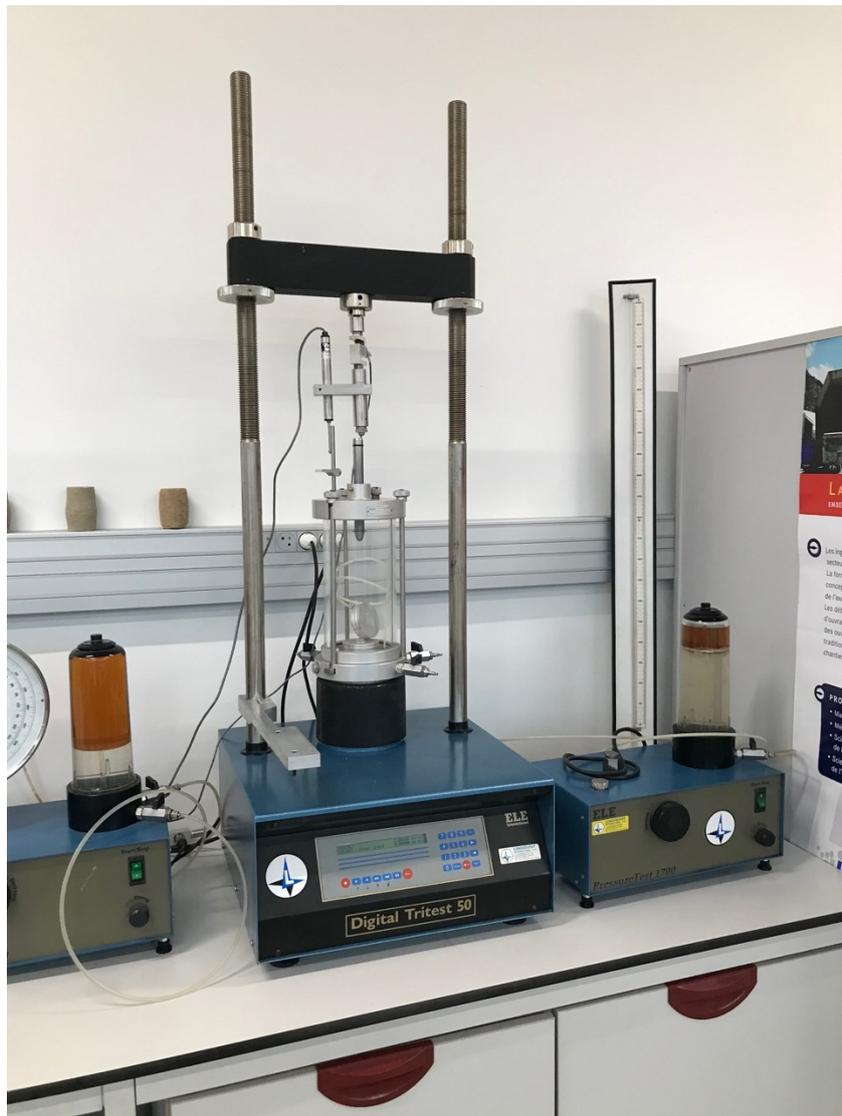
Figure 5 : Appareil pour un essai triaxial
