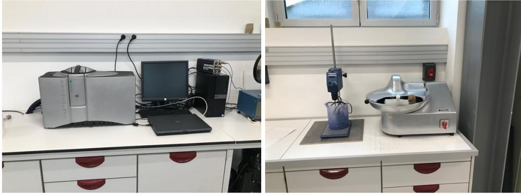
Figure 4 : Granulomètre laser (à gauche) et malaxeur (à droite)
