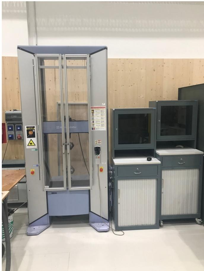
Figure 11 : Presse SHIMADZU 100 kN
